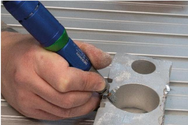
Mit dem „Schnellläufer“ wird ein Werkstück abgeschliffen. | joke Technology GmbH
